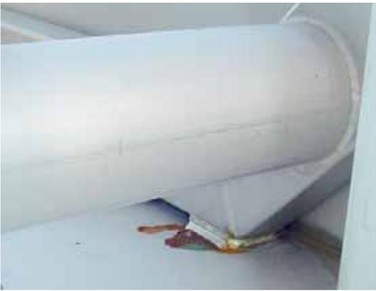
Auslaufen von Beizrückständen an nicht dicht geschweißten Rohren
