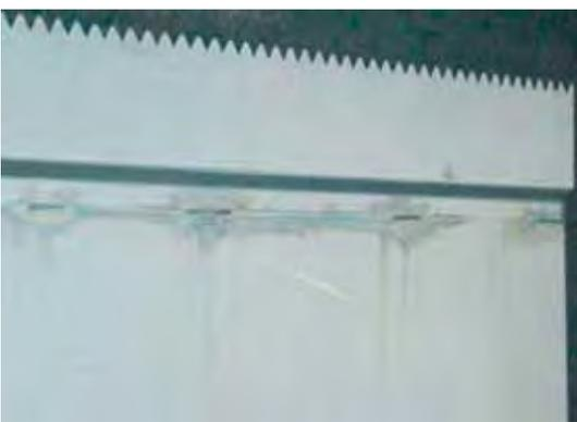
Doppelungen im Schweißnahtbereich, Schweißnähte nicht dicht geschweißt, Beizchemie in Doppelungen – unsauber gespült
