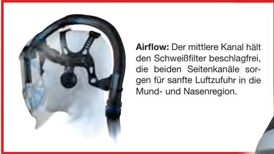
**Airflow:** Der mittlere Kanal hält den Schweißfilter beschlagfrei, die beiden Seitenkanäle sorgen für sanfte Luftzufuhr in die Mund- und Nasenregion.
