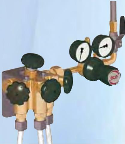
Der Verteilerblock MANYFLOW ermöglicht durch sein Baukastensystem Druckregelstationen für Acetylen und hochverdichtete Gase bis 300 bar sowohl für die Flasche als auch für die Bündelversorgung. Es stehen Stationen für unterschiedliche Gasentnahmemengen zur Verfügung.
