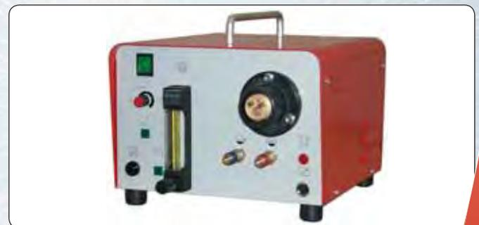
Als preiswerte Einstiegslösung zum Plasmaschweißen werden Systeme angeboten, die es ermöglichen, in Verbindung mit einem wassergekühlten WIG-DC Schweißgerät einfache Schweißanlagen zu einer Gleichstrom-Plasmaschweißanlage auszubauen.
